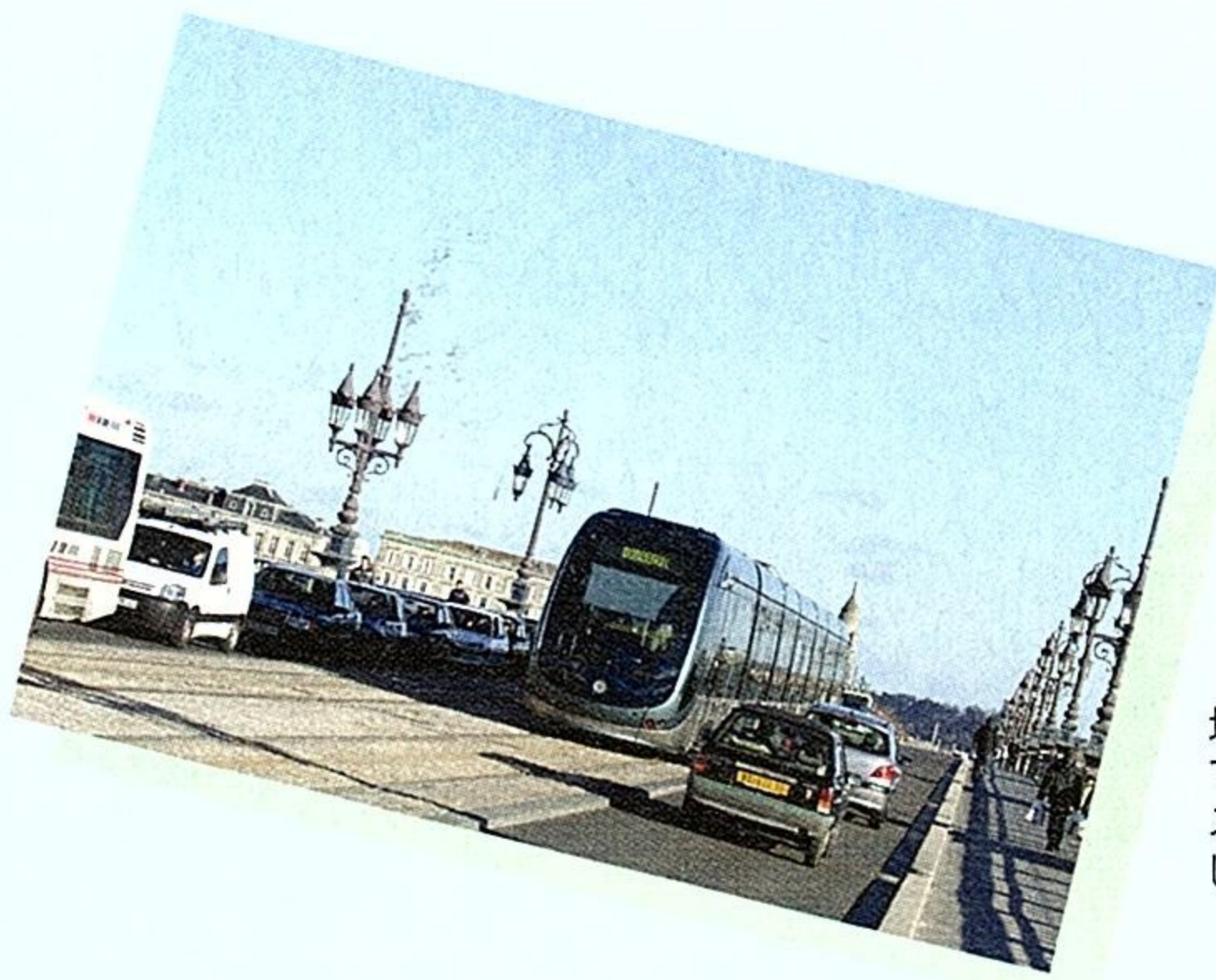
地表集電システムを世界で初めて採用したボルドー市を走るアルストム。これにより架線レスを実現し、注目を集めている
