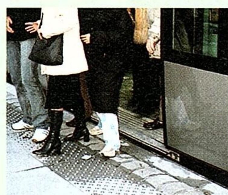
段差のない超低床式車両
